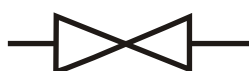
Вариант 3. Знак "Вентиль проходной". Шаровой кран так обозначать неверно, но обозначают так часто.
